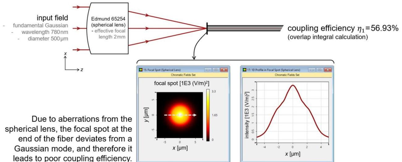
シングルモードファイバーに光をカップリングするタスクで、2つの市販のレンズを選択し、その性能を重なり積分を用いて評価します。
